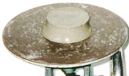
テーブルフロー試験（振動前）
